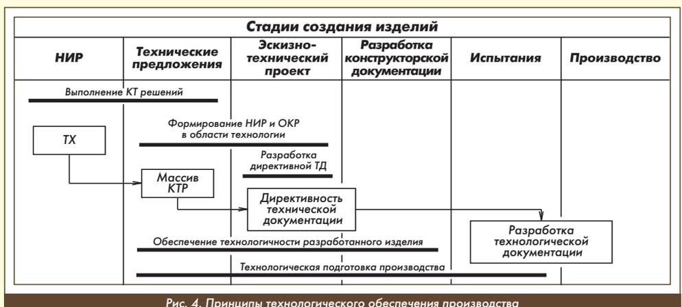
Рис. 4. Принципы технологического обеспечения производства
