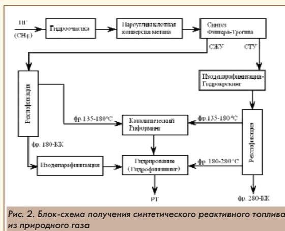
Рис 2. Блок-схема получения синтетического реактивного топлива из природного газа
