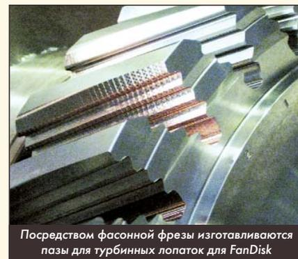
Посредством фасонной фрезы изготавливаются пазы для турбинных лопаток для FanDisk
