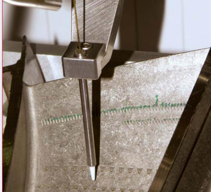
Станки фирмы Sarix способны прошивать отверстия под любым углом
